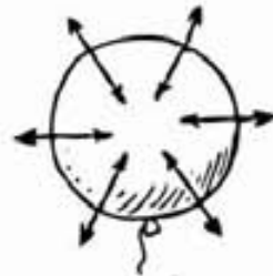
El aire comprimido empuja la pared del globo hacia fuera.
