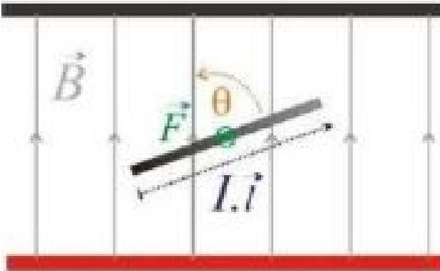
**27.25** Fuerzas sobre una carga móvil positiva en un conductor que transporta corriente.
