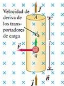
**27.26** Segmento recto de alambre con longitud  $l$  que lleva una corriente  $I$  en la dirección de  $\vec{l}$ . La fuerza magnética en este segmento es perpendicular tanto a  $\vec{l}$  como al campo magnético  $\vec{B}$ .
