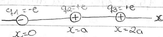
Presenta el arreglo final de las tres cargas. Para determinar el trabajo que se requiere para traer a  $q_3$  del infinito, se usa la ecuación 23.10 para encontrar la energía potencial asociada con  $q_3$  en la presencia de  $q_1$  y  $q_2$ . Despósés se emplea la ecuación 23.11 para determinar la energía potencial total del sistema.
