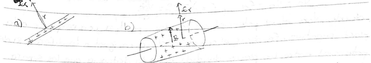
Como el campo sólo tiene una componente radial, el producto escalar  $\vec{E} \cdot d\vec{l}$  es igual a  $E_r dr$ . Así, el potencial de cualquier punto a con respecto a cualquier otro punto b, a distancias radiales  $r_a$  y  $r_b$  de la línea de carga, es
