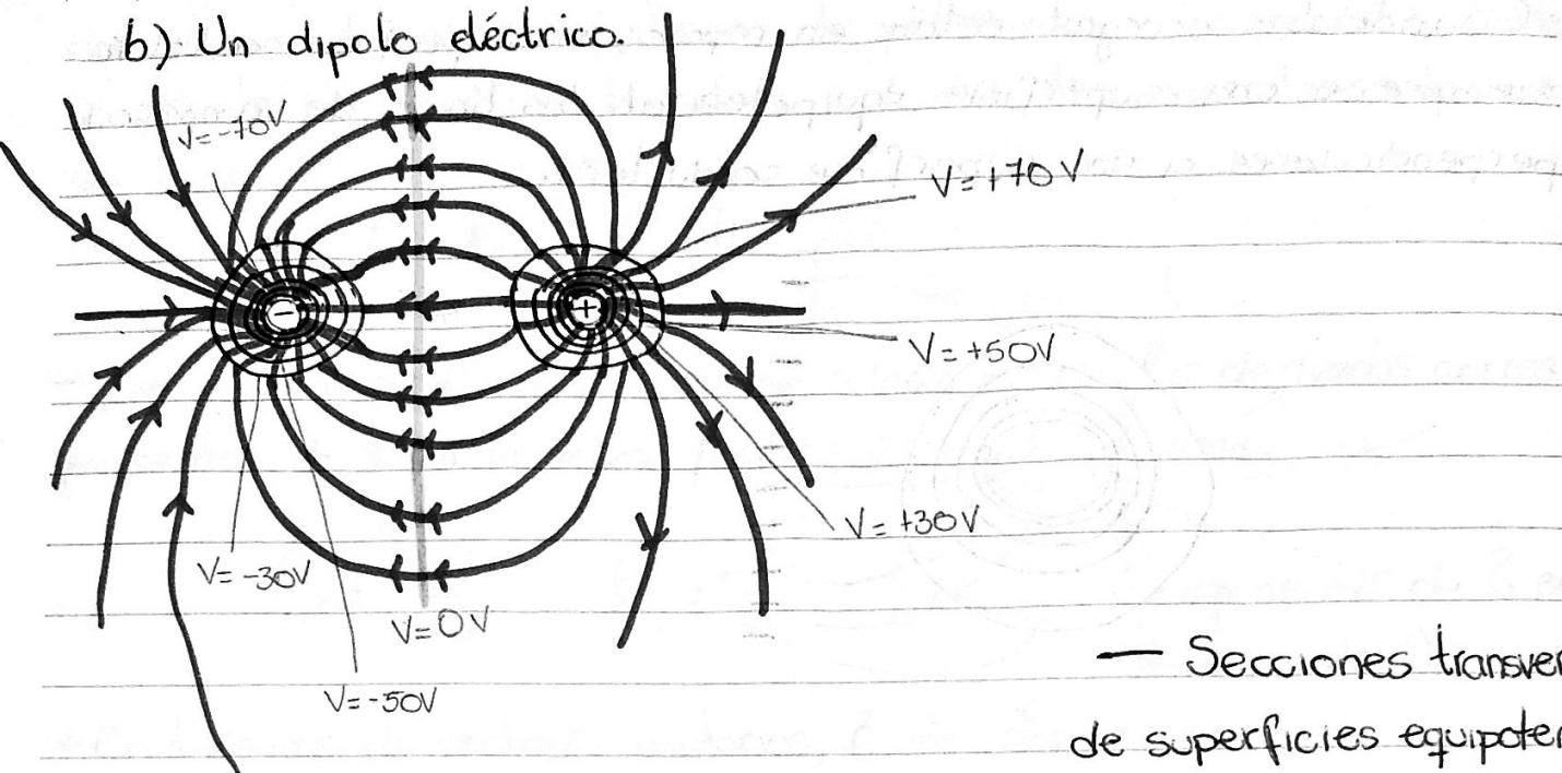
— Secciones transversales de superficies equipotenciales
